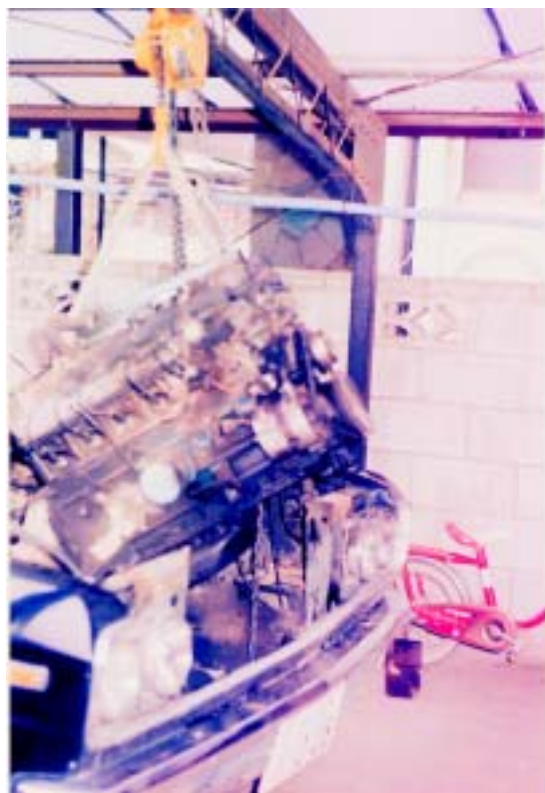
H130 型セドリック車から降ろされる 6気筒ガソリンエンジン（1975年頃 自宅車庫にて）
