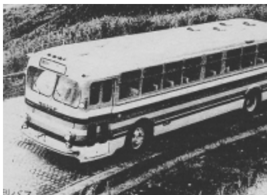
6 RFA101 型エアサス高速観光バス (試作車 1956年 230PS)
