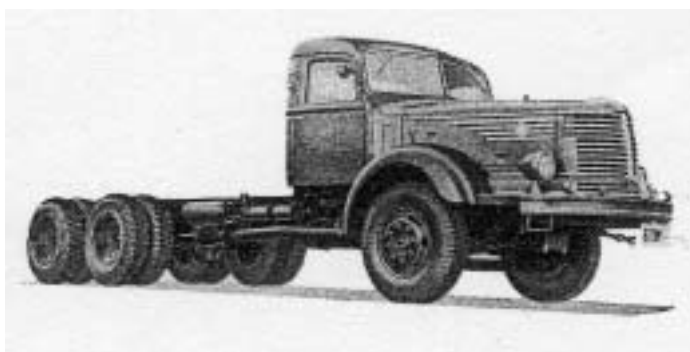
日本初3軸10トン積みトラック 6TW10 型
