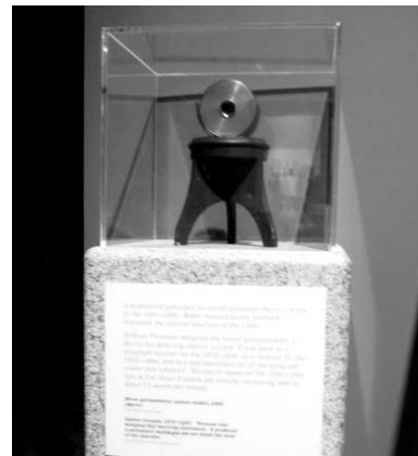
写真2 ケルビン のミラーガルバノメータ (中央窓の中の鏡がわずかに動き信号を伝える)
