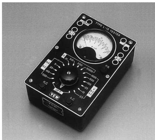
図4 アナログテスタと目盛指針：レンジによって目盛がちがう
