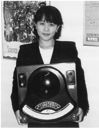
図4 標準用計器DLS(1981年まで製造) 外形40cm×40cm,重量11kg
