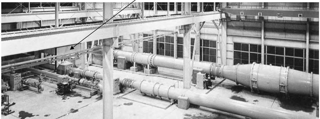
ラインの右側は被校正電磁流量計の 2400mm と 1000mm。
