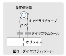
これは本当です。差圧式流量計のほとんどのトラブルは、差圧を差圧伝送器に導く導圧管に起因するといってよいでしょう。しかし、導圧管はダイヤフラムシールに置き換えることもできます(図3)。また近年差圧伝送器の改良によって、ゼロ点調整用の三岐弁の必要性が減り、差圧伝送器を配管に直接取付けるダイレクトマウント方式が増えました。この場合、導圧管部はきわめて短く、トラブルが減少します。
